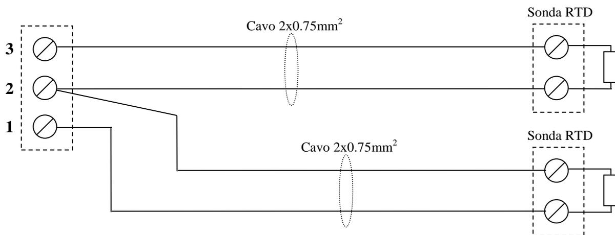
Posare il cavo di connessione alla sonda in modo separato rispetto a linee di potenza, se si utilizza un cavo schermato connettere lo schermo solo da un singolo lato. Se le lunghezze dei cavi raggiungono distanze notevoli, utilizzare cavi con sezione maggiore in modo da minimizzare la resistenza serie degli stessi. E' possibile eliminare la resistenza dei cavi attraverso una resistenza campione ed una procedura di taratura sul programma di configurazione.
