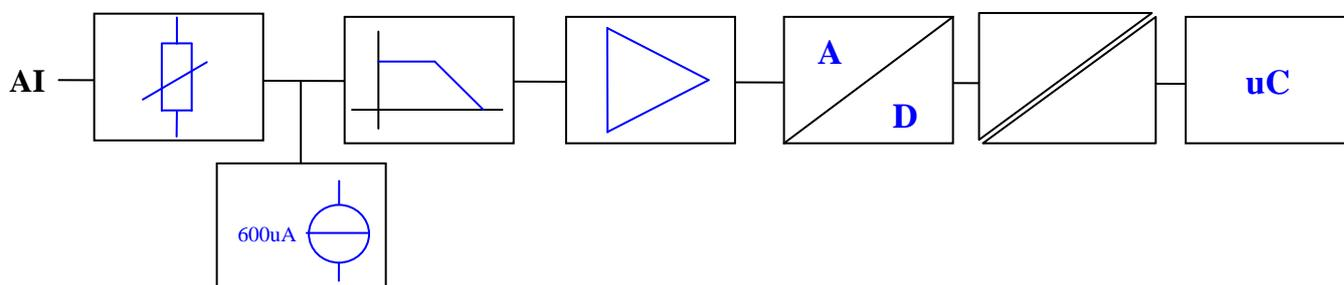
Il generatore di corrente genera una corrente verso la sonda di 600uA, la sonda al massimo carico (1700Ω) genera una potenza di auto riscaldamento pari a 0.61 mW, verificare in caso di utilizzo di sensori di temperatura RTD che questo non provochi un auto riscaldamento eccessivo della sonda.
